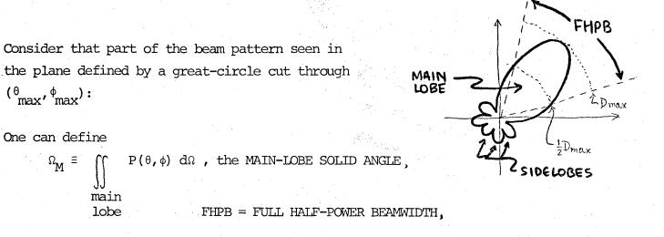
and  $n_{\rm B} \equiv \Omega_{\rm M} / \Omega_{\rm A} \stackrel{<}{=} 1$ , the BEAM EFFICIENCY.
