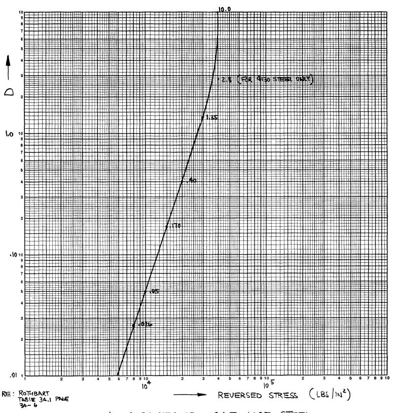
DAMPING CAPACITY OF SAE 1025 STEEL
