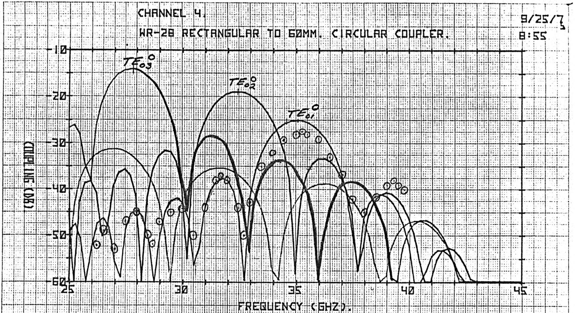
TE0 1 MODE, 112 COUPLING UNITS SPACED 2.170MM. APART.
