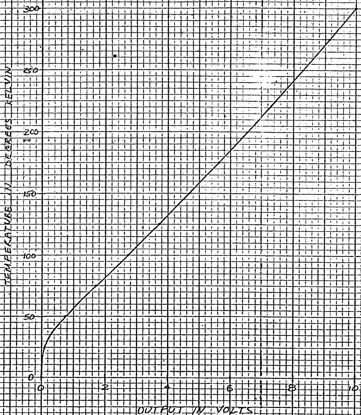
TEMPERATURE VS OUTPUT VOLTAGE
