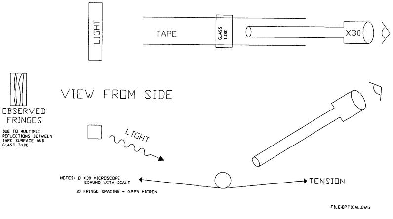
FIG. OPTICAL INTERFEROMETER TO MEASURE TAPE ROUGHNESS
