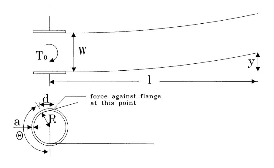
FIGURE 1. I/O ROLLER GEOMETRY
