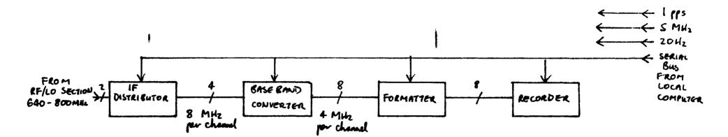
FIGURE 2: THE DATA ACQUISITION TERMINAL
